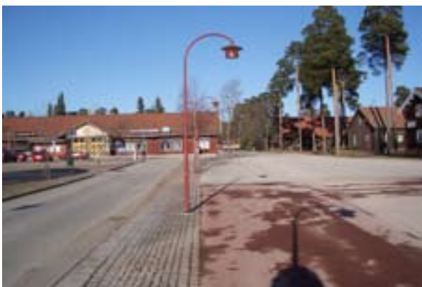
Jan Ejheds specialritade betongarmatur för stråket mot Långbryggan. Nederst i bilden de rödfärgade betongplanken i stråket.
